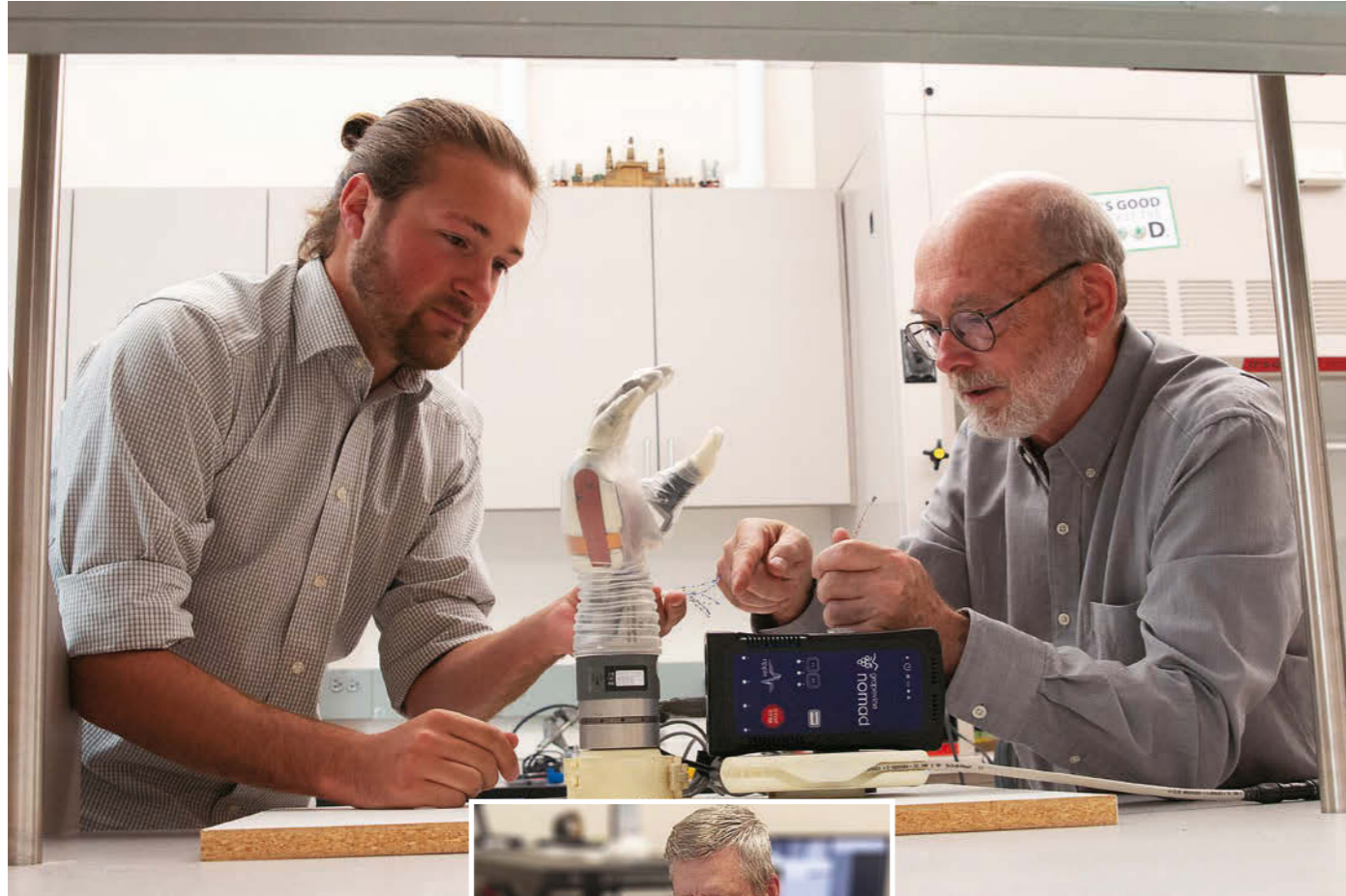
Prototyp mit Gefühl. In den Forschungslaboren wird bereits mit Prothesen experimentiert, die dem Träger einen rudimentären Tastsinn vermitteln (oben). Das erleichtert den Umgang mit empfindlichen Objekten wie zum Beispiel beim Traubepflücken (links).
